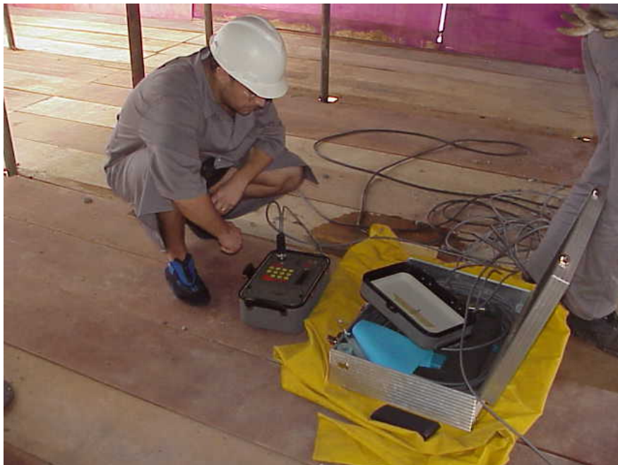
Foto 10 - O Potencial Eletroquímico de Corrosão e a Densidade de Corrente foram medidos pelo GECOR 6. Esse ensaio era feito após a localização e determinação da área de aço de cada ponto medido
