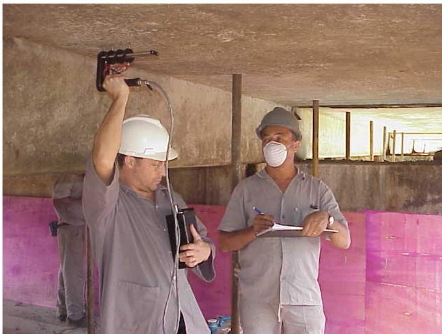
Foto 8 - A medida da resistividade foi feita com o aparelho de Wenner. Os dados são obtidos de forma simples e rápida
