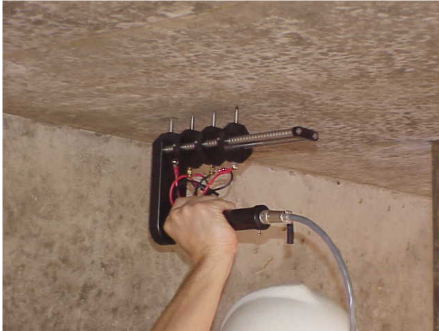
Foto 9 - Detalhe do aparelho de Wenner, que é composto de quatro eletrodos
