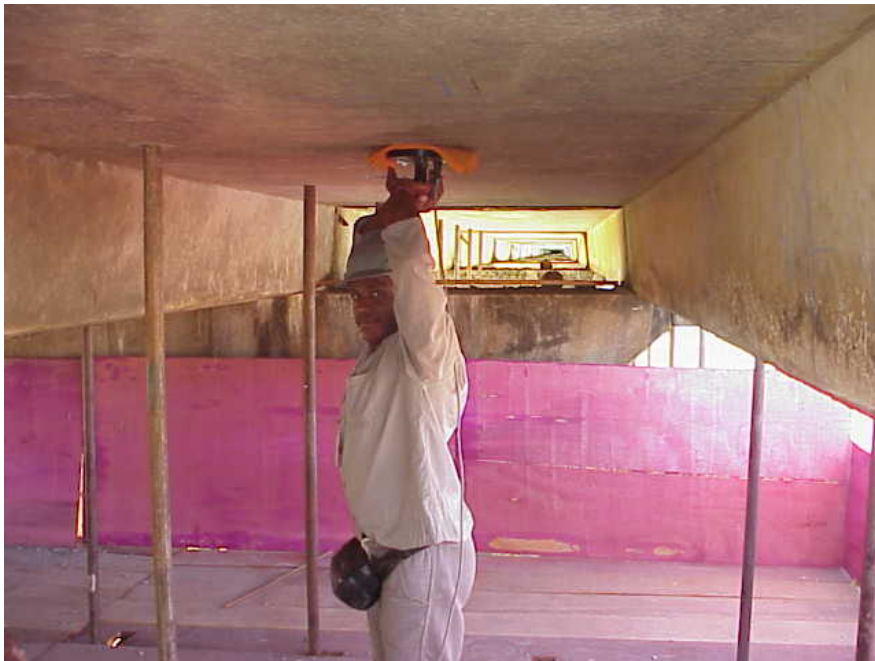
Foto 13 - O disco de contato tinha que ser fixado com precisão para a realização das medidas
