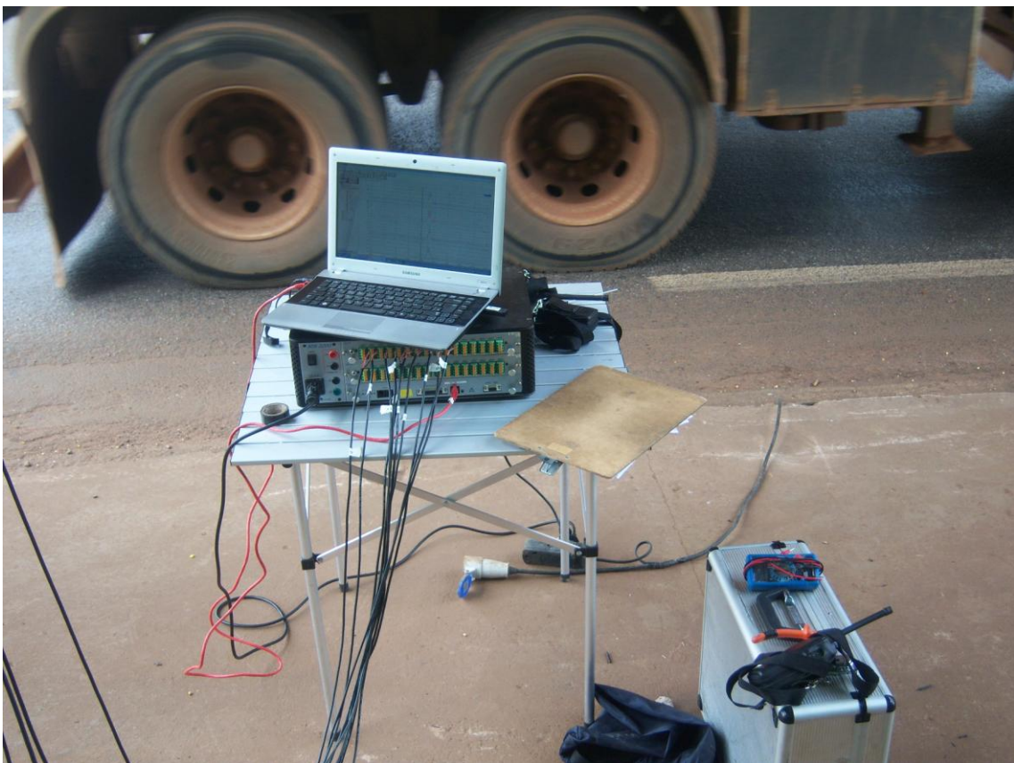
Foto 7 – Sistema de aquisição de dados e notebook para o monitoramento em tempo real
