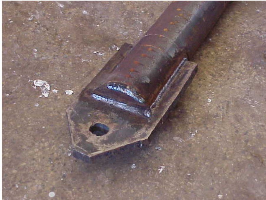
Foto 9 – Tubo de reforço pronto para ser instalado
